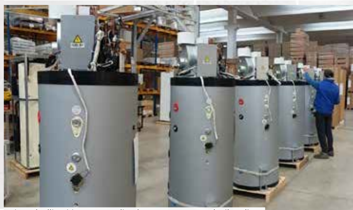
Linea bollitori in pompa di calore - Heatpump boilers line
