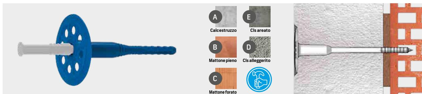
Tasselli di espansione a percussione in materiale sintetico con perno premontato in poliammide con riduzione della conducibilità termica puntuale (0,001W/K), omologato per tutti i materiali da costruzione (A, B, C, D, E) e certificato ETA 014
