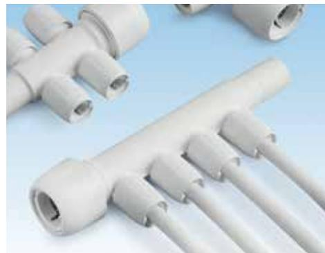
Il sistema **Heptherm** è costituito da tubazioni preisolate in PB, collettori e raccorderia ad innesto rapido. Le tubazioni **Heptherm** sono leggere e maneggevoli, resistenti e di lunga durata per le condizioni di pressione e temperatura impiegate nel riscaldamento, ma non sono idonee al passaggio di acqua potabile. L'isolamento è garantito da una guaina in polietilene (PE) espansa a struttura cellulare chiusa, con pellicola antigraffio di colore rosso.
