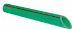
Tubi Fiber Basalt Plus in barre da 4mt. De 20-63 S 3,2/SDR 7,4/PN28 (Calcolato) De 75-125 S 4/SDR 9/PN22 (Calcolato)
