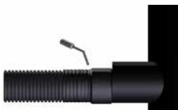
Scaldare con precauzione la guaina termoretrattile con un fon ad aria calda o un becco a gas per garantire l'ermetizzazione della guaina esterna rispetto al pozzetto. Attenzione: indossare guanti da lavoro resistenti al calore!
