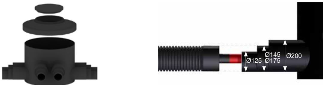
Per preparare i tubi al collegamento nel pozzetto, dotarli di una calotta a ritrazione. A tale scopo spingere la calotta a ritrazione sopra la guaina esterna e il tubo del fluido. Con un fon ad aria calda o un becco a gas con fiamma debole gialla (NON usare una fiamma blu), far contrarre con precauzione la calotta a ritrazione.
