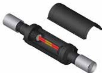
2. Infilare le guaine termoretrattili e gli inserti tubolari isolanti sui manicotti. Unire i tubi del fluido a pressione o saldandoli (istruzioni per il montaggio "UNIONE A PRESSIONE") e verificare la tenuta delle tubo del condotto. Eseguire una prova a pressione!
