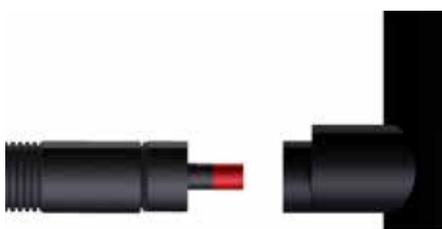
Prima di collegare i tubi nel pozzetto, spingere la guaina termoretrattile sopra il tubo. Poi introdurre i tubi nel pozzetto e stabilire tutti i necessari attacchi e collegamenti nel pozzetto.
