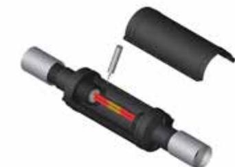
3. Avvolgere i tubi del fluido con il materiale isolante e fissare quest'ultimo con il nastro adesivo fornito. (Saltare questo passo se si utilizza il pacchetto isolante in PU).
