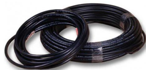
Cavo scaldante **BIPOLARE** resistivo **40W/mt** a due conduttori con schermo di protezione completa e protezione contro le radiazioni UV. Adatto per il riscaldamento di superfici esterne. Classe M2, Cavo alimentazione lungo 5mt Ø 6.3-9 mm.
