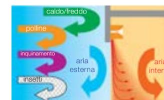
Posizionando la barriera d'aria coprendo totalmente la larghezza della porta e direttamente sopra l'apertura, le prestazioni vengono ottimizzate, fermando l'aria calda che fuoriesce in inverno o l'aria fredda che fuoriesce durante l'estate. Questo effetto barriera può aiutare a ridurre i costi energetici fino a un terzo
