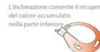
Nei casi in cui i ventilatori di de-stratificazione non sono disponibili, il posizionamento dei termoventilatori con un livello di montaggio più alto può diminuire l'effetto di aumentare l'aria calda spingendo l'aria indietro verso il livello del suolo.
