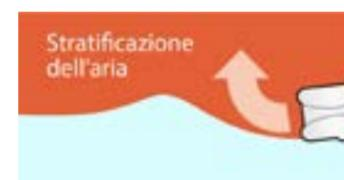
Con l'aumentare del calore, l'aria riscaldata si dirige naturalmente verso i soffitti dando una stratificazione di aria più calda al soffitto e un'aria più fredda verso il pavimento. Per questo motivo, è sempre consigliabile installare i ventilatori di de-stratificazione per mantenere l'aria calda e riscaldata in basso dove verrà maggiormente percepita.
