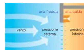
Laddove si utilizzino unità di estrazione dell'aria all'interno dell'edificio, dovrebbe essere fornita anche la ventilazione per equalizzare le differenze di pressione tra l'ambiente esterno e quello interno per la massima efficacia della barriera d'aria.
