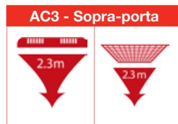
Fornisce un riscaldamento multidirezionale e potente, collocato sopra la porta dell'ingresso di piccoli negozi. Queste unità operano fino a 2,3mt dal piano. Non si possono considerare barriere d'aria ma riscaldatori sopraporta.
