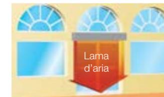
Le barriere, separano le diverse temperature di due zone, con una lama d'aria invisibile. Forniscono un flusso d'aria che si muove rapidamente, bloccando la circolazione dell'aria stessa attraverso la porta consentendo di mantenerla aperta
