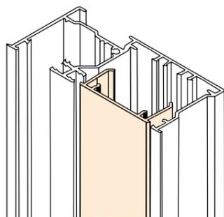
Profilo di chiusura da usare quando non si intende completare l'installazione della zanzariera
