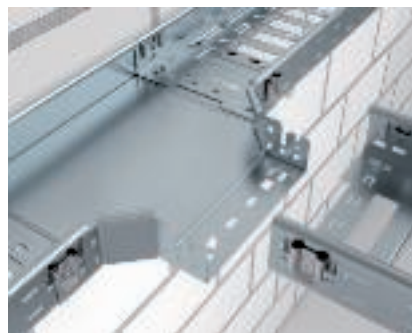
Montaggio della derivazione a T Magic Installazione di curve in maniera semplice. Il lato della passerella con la molla si innesta dall'alto nella curva.
