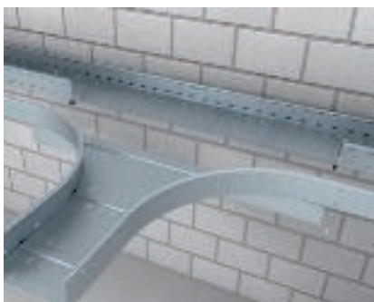
Montaggio della derivazione laterale Derivazione laterale in combinazione con passerella portacavi a grande portata. Per il montaggio il longherone laterale viene separato.
