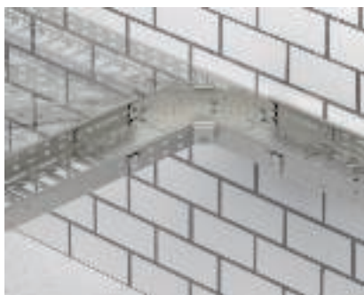
Deviazione di direzione tramite Bogen Magic variabili Con la curva variabile Magic del tipo RBMV...è possibile inserire deviazioni di direzione continue da 0° a 90° nella guida linee.
