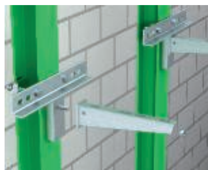
Fissaggio al supporto verticale Montaggio della piastra tipo KA-AW al supporto in acciaio verticale tramite angolari di fissaggio o staffe di serraggio. Alla piastra vengono poi fissate mensole a parete tipo AW con la vite a testa esagonale tipo SKS 12x40 GF.
