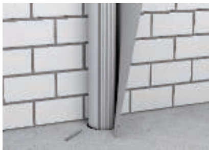
Installazione della fascia resistente al fuoco
