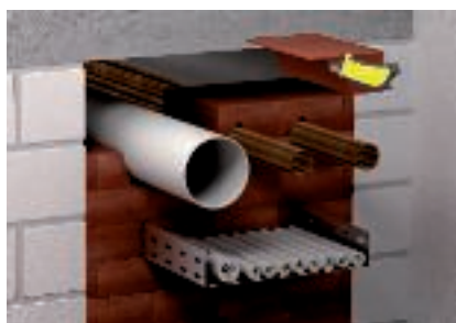
Passaggio di tubi incombustibili senza l'utilizzo dei collari
