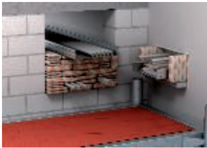
Chiusura dell'apertura con sacchetti - senza stucco o rivestimento
