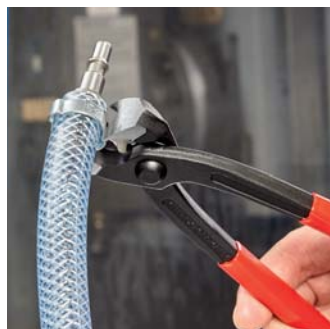
Ermetizzazione di tubo pneumatico su giunto rapido con bassetta anteriore di compressione
