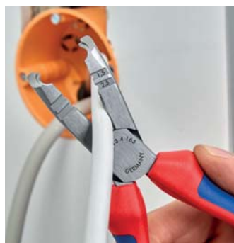
Taglio di cavi fino a Ø 13 mm
