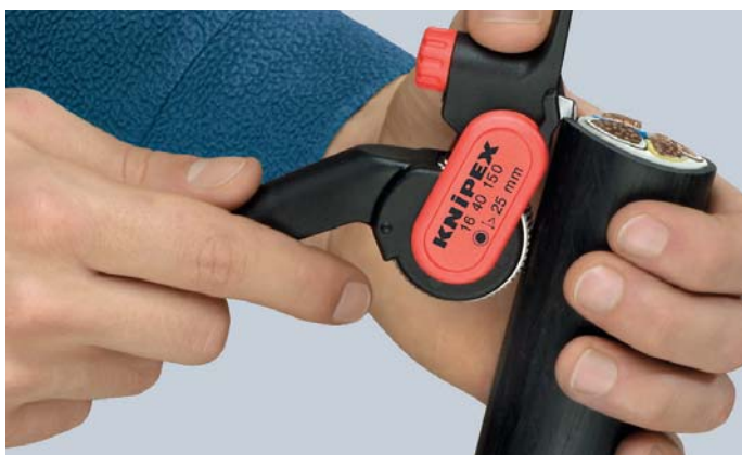
Posizionamento dell'utensile per taglio longitudinale
