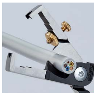
Tagliante temperato a induzione e rettificato di precisione per tagliare cavi di rame e di alluminio fino al Ø 15 mm (5 x 2,5 mm 2 ) senza rischio di schiacciamenti
