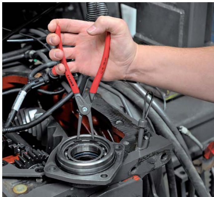
Punte stabili in acciaio ad alta densità inserite nel becco
