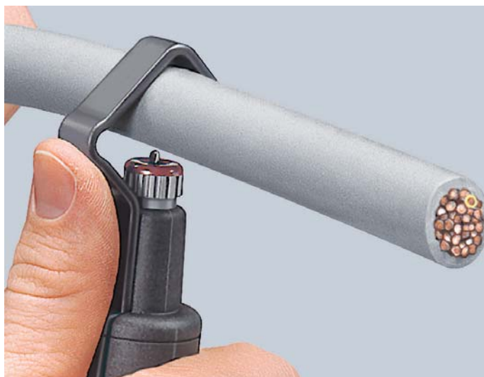
Posizionamento dell'utensile per taglio perimetrale
