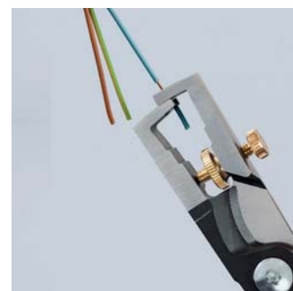
Contrassegno lunghezza: i contrassegni rappresentano un valido ausilio in caso di spelatura in serie nelle lunghezze più comuni (11 mm e 16 mm)
