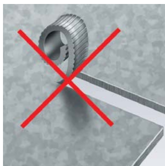
Intaglio senza rottura del truciolo
