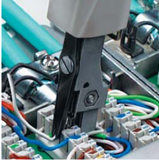
Inserzione e taglio in un'unica operazione
