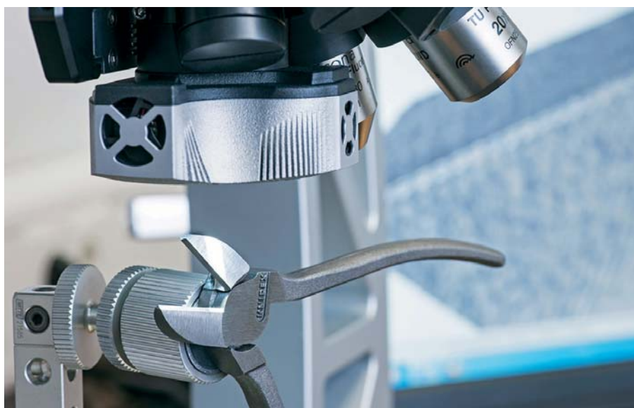
Nel tranchese laterale, la forma e la ruvidità del tagliente vengono misurate in modo preciso con un sistema di misura ottico 3D.
