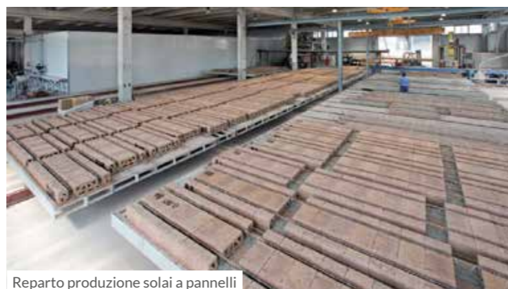
Reparto produzione solai a pannelli
