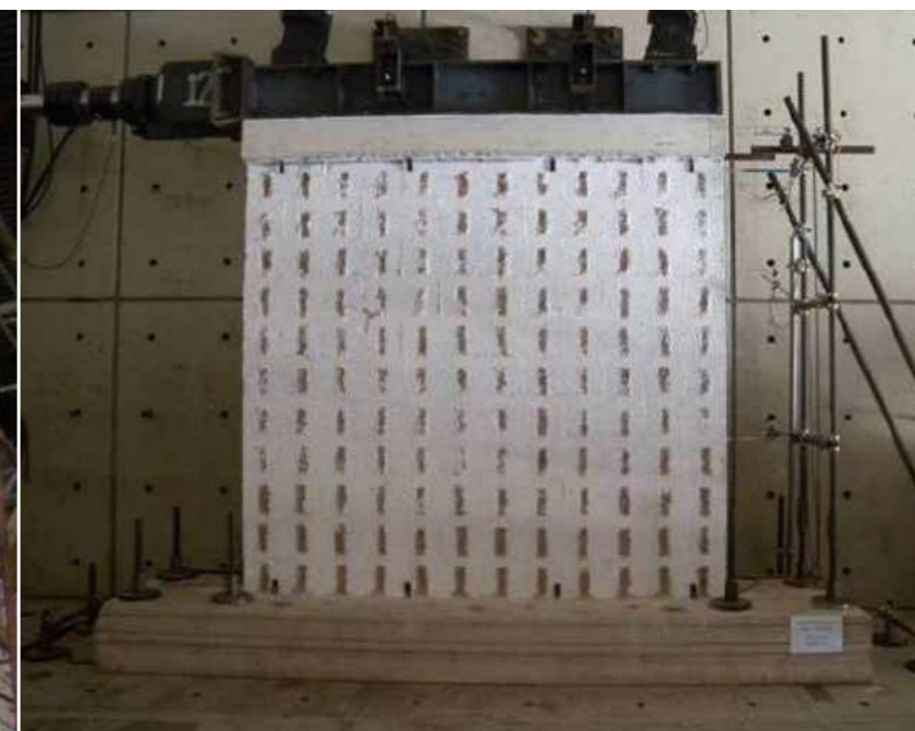
Sopra: Prova sismica su parete ISOTEX piena A sinistra: Prova sismica su parete ISOTEX di due piani A destra: Prova sismica su parete ISOTEX con finestra
